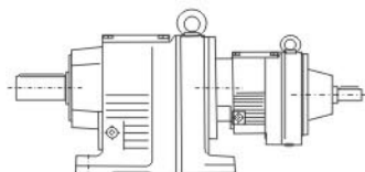
R...R... 底脚轴伸式安装组合型，轴输入的斜齿轮减速机
